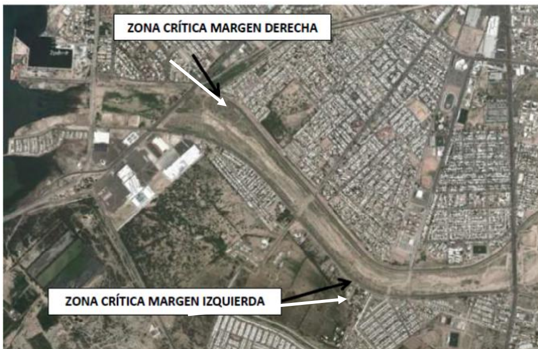
Imagen 134: Zonas críticas en encauzamiento del arroyo el Piojillo
